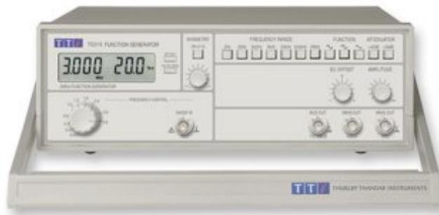
Figure 2. Générateur basse fréquence TG315
